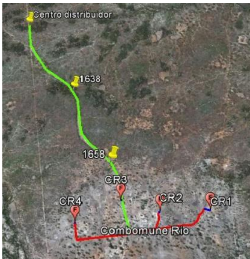
Figura 4 – Rede e adução previsto do subsistema 1
